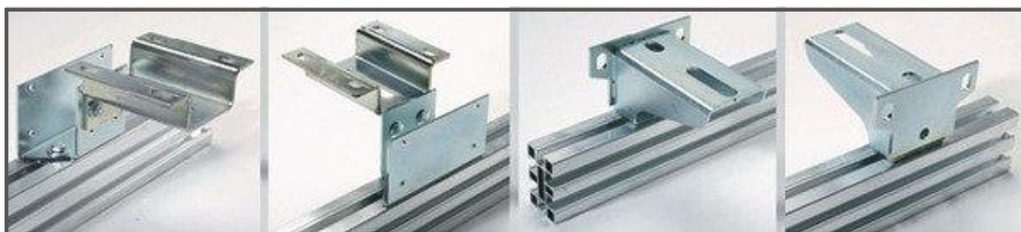
3 Konsolen aus verzinktem Stahl, um eine stabile Befestigung der Führung zu garantieren und die einfache Faltung des Flügels auch bei 180° zu ermöglichen.
